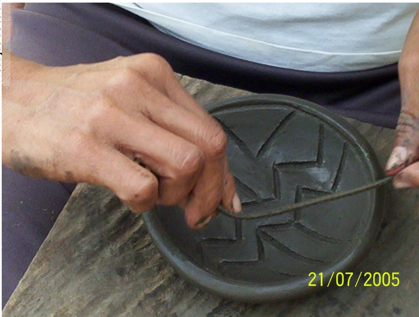
FIGURA 6: Marcação do Desenho com o Cordão de Caraguatá.
