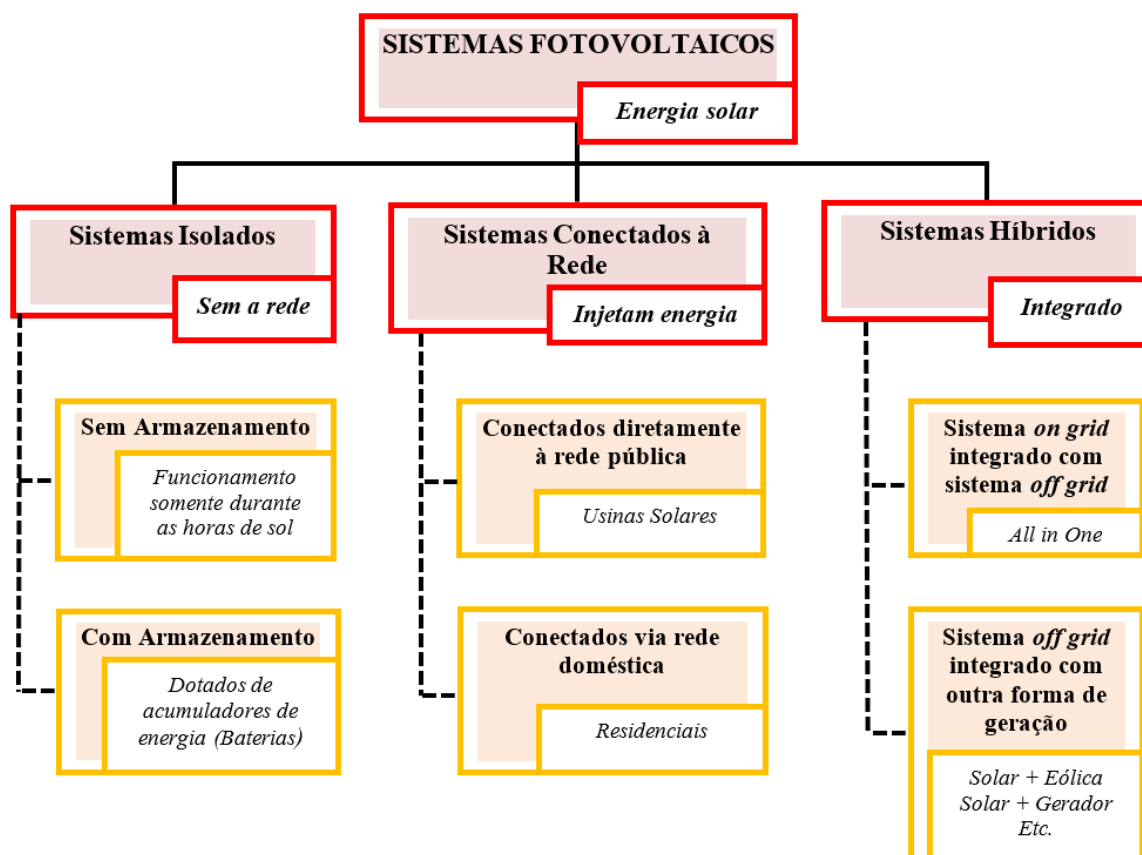
Figura 5 – Tipos de sistemas fotovoltaicos.
