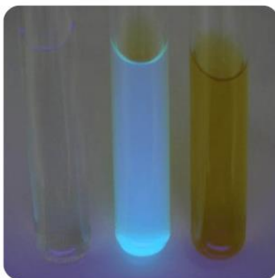
Figura 5. Análise de presença e ausência de Escherichia coli (fluorescente) e coliformes totais.
