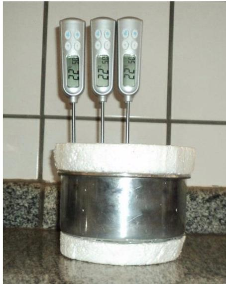
Figura 1 – Recipiente cilíndrico metálico destinado à transferência de calor com fluxo unidimensional, radial.
