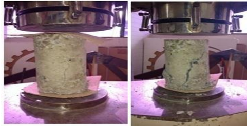
Figura 2: Ruptura característica do corpo de prova de concreto. Fonte: Autores, 2017
