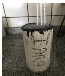
Figura 2: Corpo de prova pronto para ensaio em banho termostatizado. Fonte: Autores, 2017
