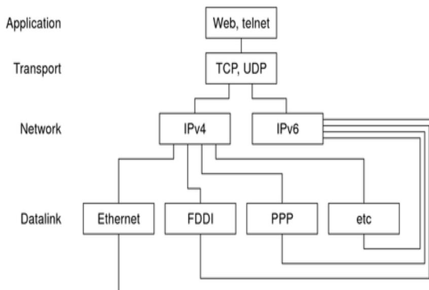
Figura 4: – Pilha dupla na camada de Rede (IP)
