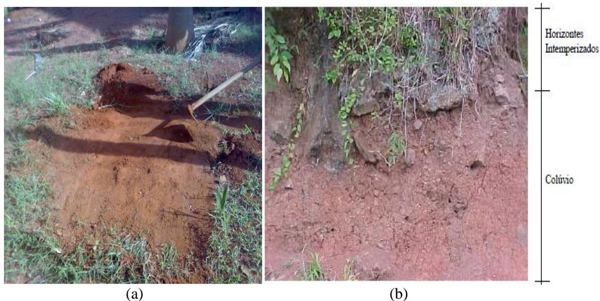
Figura 1 - (a) Solo Latossolo Vermelho em campo experimental estudado por Araujo (2010); (b) Perfil do solo Argissolo Vermelho Amarelo estudado por Feuerharmel (2007).
