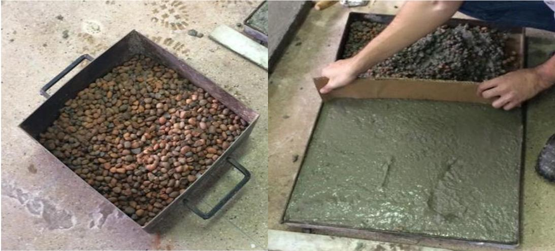
**Figura 03** – A esquerda, aspectos das argilas expandidas, a direita o concreto com a argila expandida ocupando metade da placa.
