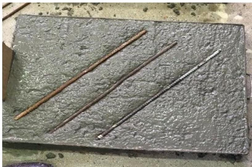
**Figura 04** – Placa com vergalhões e concreto.
