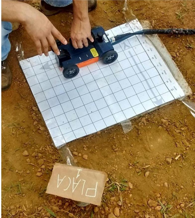
**Figura 5** - Processo de aquisição das linhas para leitura com o GPR.
