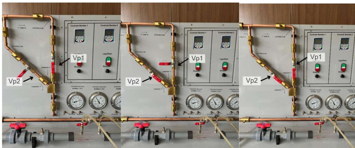
Figura 2 – Configurações 1, 2 e 3 de abertura das válvulas.
