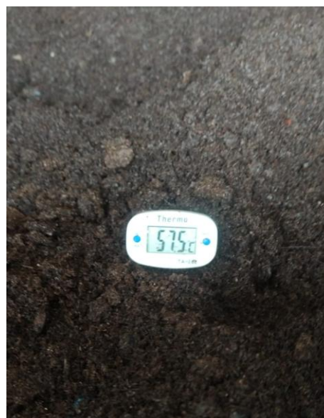
Figura 5 - Temperatura composteira na fase termofílica.
