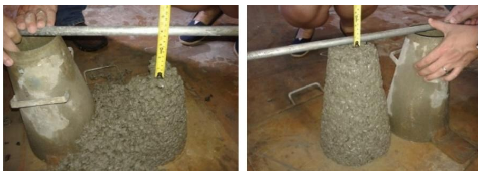
Figura 4 – Ensaio de abatimento pelo tronco de cone. Fonte: Autores.
