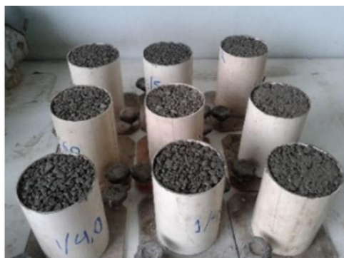
Figura 3 – Moldes em PVC para moldagem do concreto permeável. Fonte: Autores.
