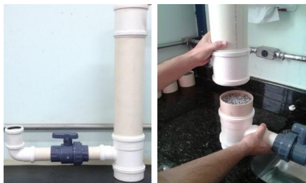
Figura 5 – Equipamento para medir permeabilidade do concreto permeável. Fonte: Autores.
