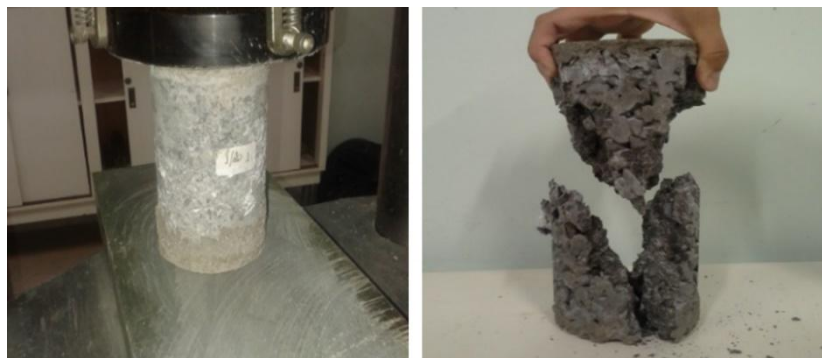
Figura 6 – Rompimento de corpo-de-prova de concreto permeável. Fonte: Autores.
