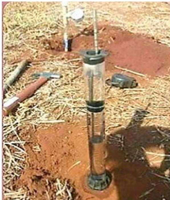
Figura 6. Aparelhos utilizados nos experimentos de condutividade e tensão matricial do solo. Foto: Autores.
