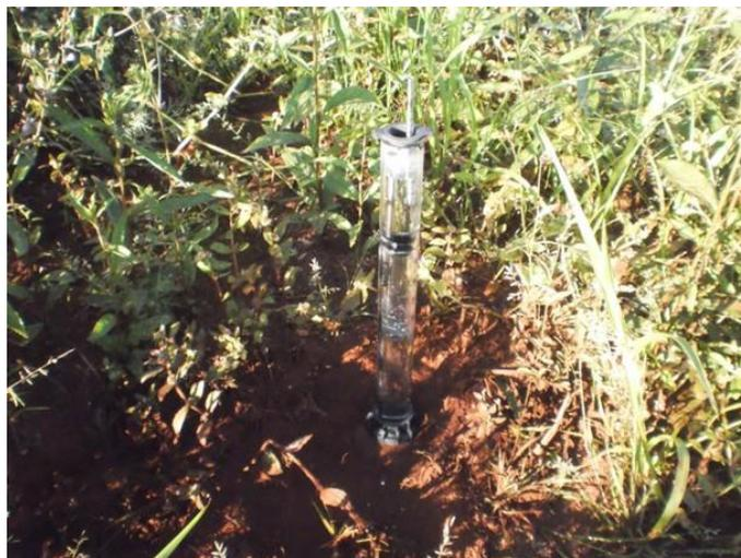
Figura 2. Infiltrômetro Mini-Disk. Fonte: Sousa et al. (2017).
