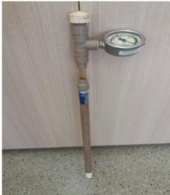
Figura 1. Tensiômetro de mercúrio. Foto: Autores.
