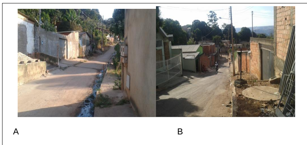
A – Esgoto a céu aberto em Rua do Novo Paraíso. B – Fossa em calçada no Novo Paraíso.
