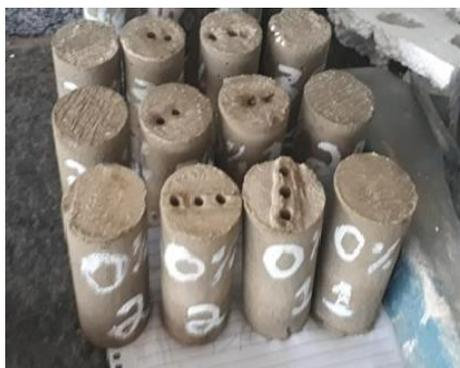
**Figura 1:** Moldagem dos corpos de prova.
