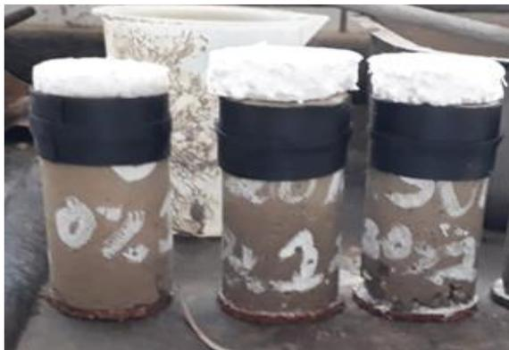
**Figura 3:** Corpos de prova.
