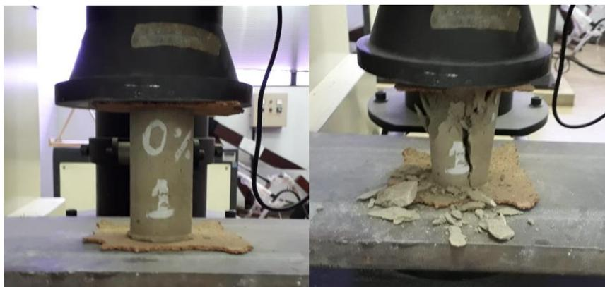
**Figura 2:** Ensaio de compressão axial.
