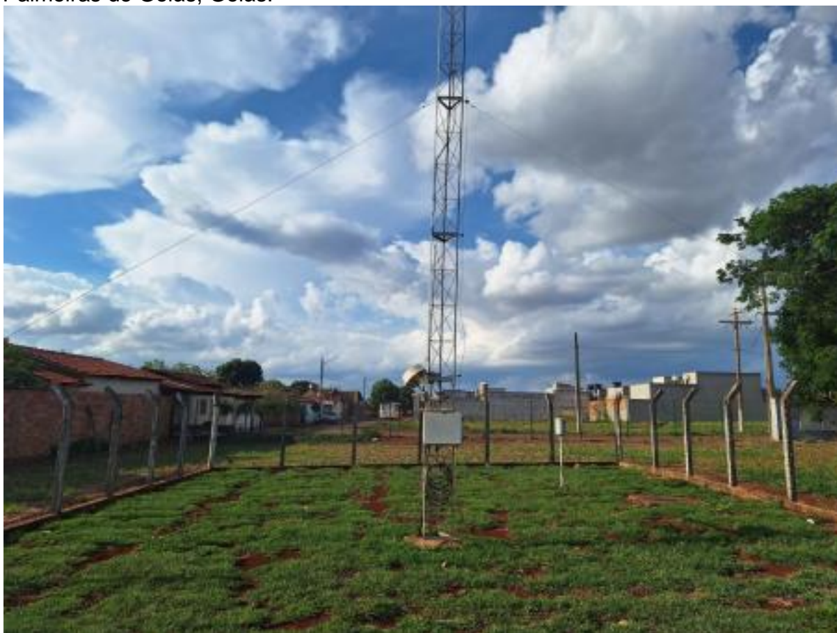
Figura 3 – Estação Meteorológica Automática (EMA) operada pelo LAAC/UEG, Palmeiras de Goiás, Goiás.
