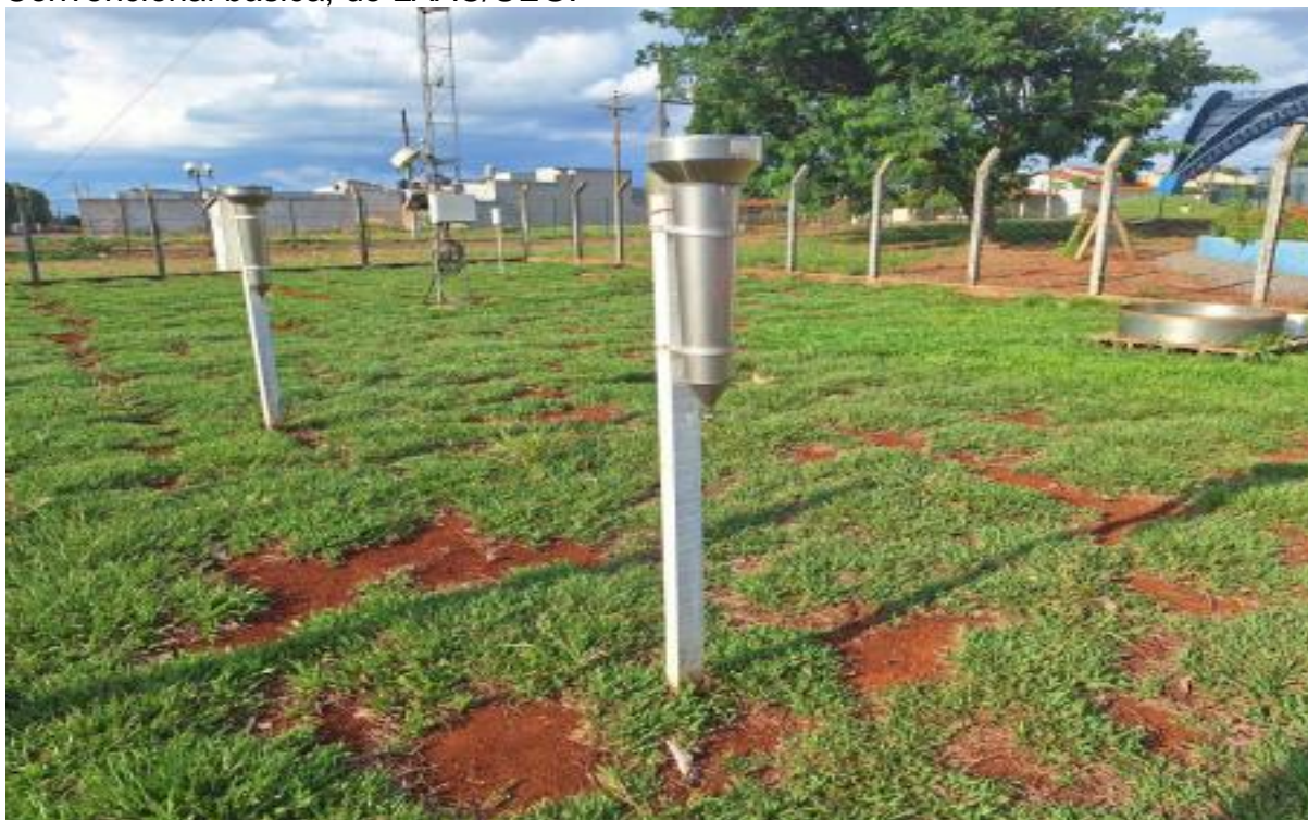
Figura 1 – Pluviômetro ordinário, instalado no cercado da Estação Climatológica Convencional básica, do LAAC/UEG.
