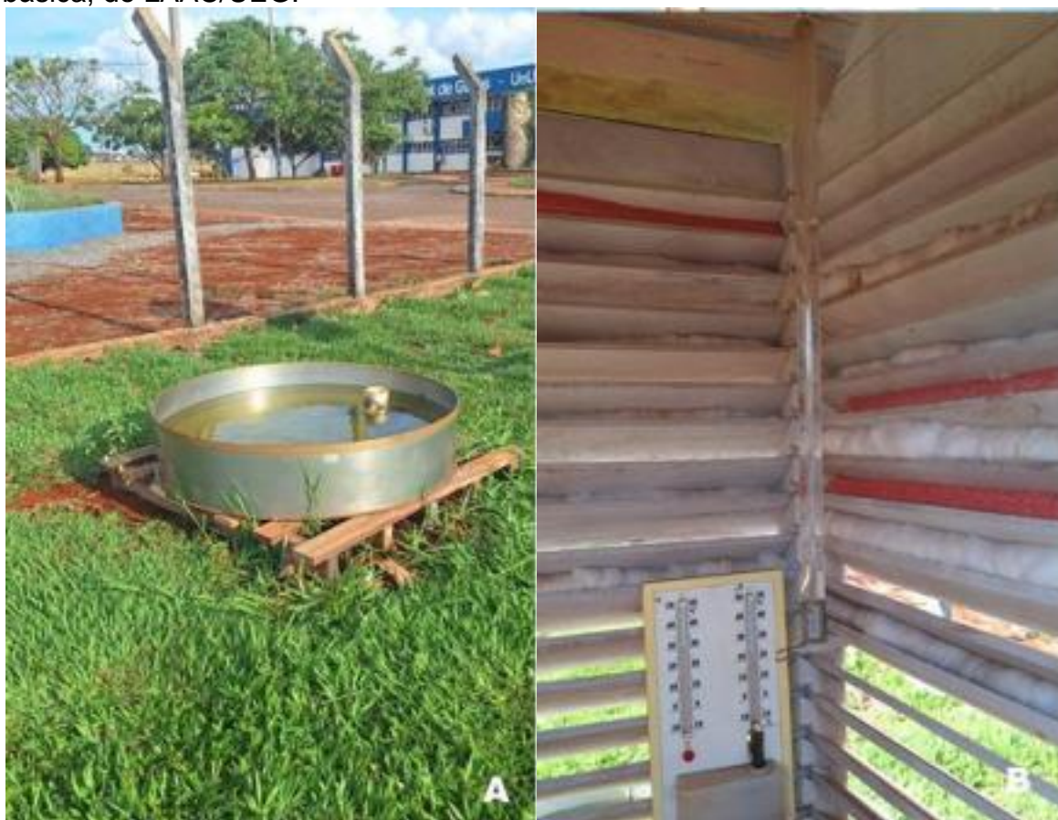
Figura 2 – a) Tanque Classe A instalado no cercado; b) Evaporímetro de Pichê instalado no Abrigo Meteorológico, da Estação Climatológica Convencional básica, do LAAC/UEG.
