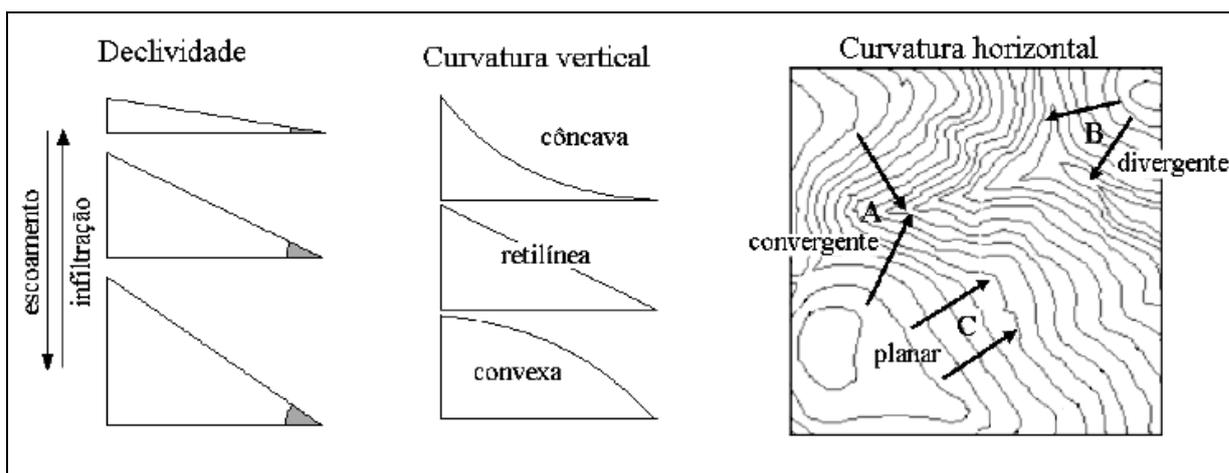
Figura 03 – Esquema da variação das declividades, curvatura vertical e curvatura horizontal.
