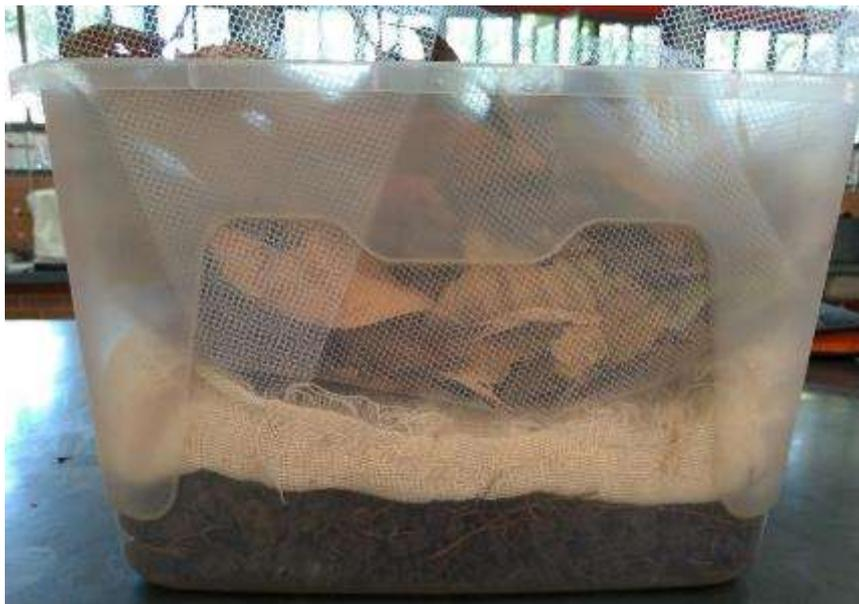
**Figura 2.** Armadilha utilizada para captura *ex situ* dos microrganismos eficientes, feita com caixa plástica transparente, correspondendo ao tratamento T3. Ipameri, Goiás. Fonte: Sousa et al., (2020).
