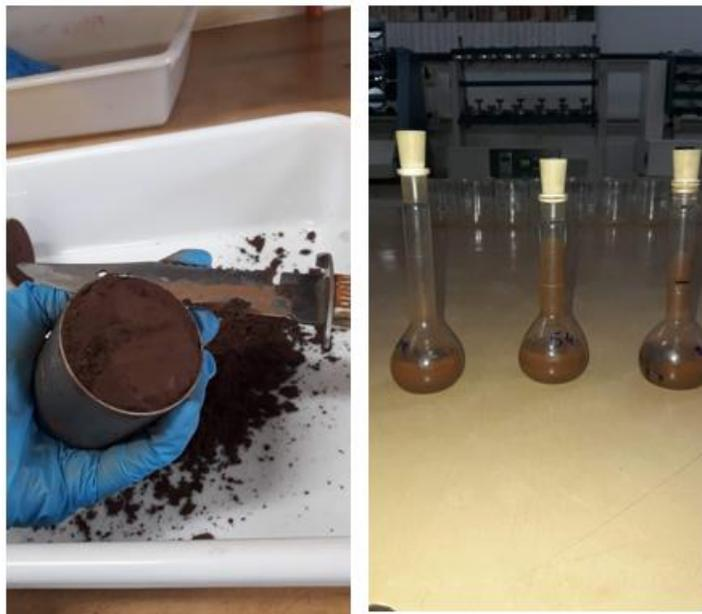
**Figura 4.** Amostra indeformada do rejeito para análise de densidade de partículas pelo método do balão volumétrico.
