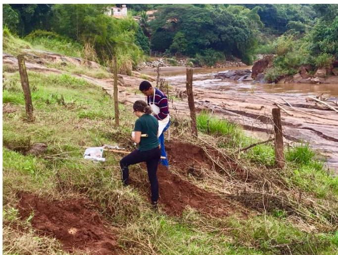
**Figura 1.** Equipe em campo para coleta de amostras deformadas e indeformadas.
