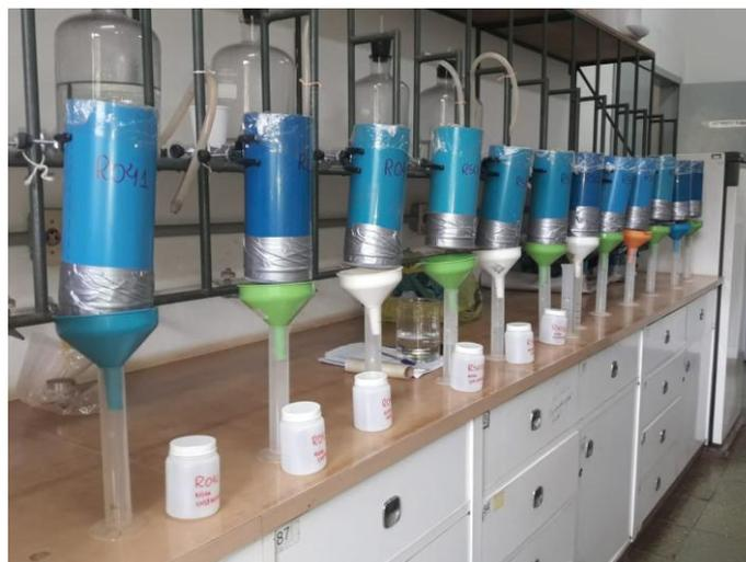
**Figura 5.** Colunas de lixiviação com rejeito montadas e em operação do experimento de lixiviação no laboratório de Física do Solo da UFV.
