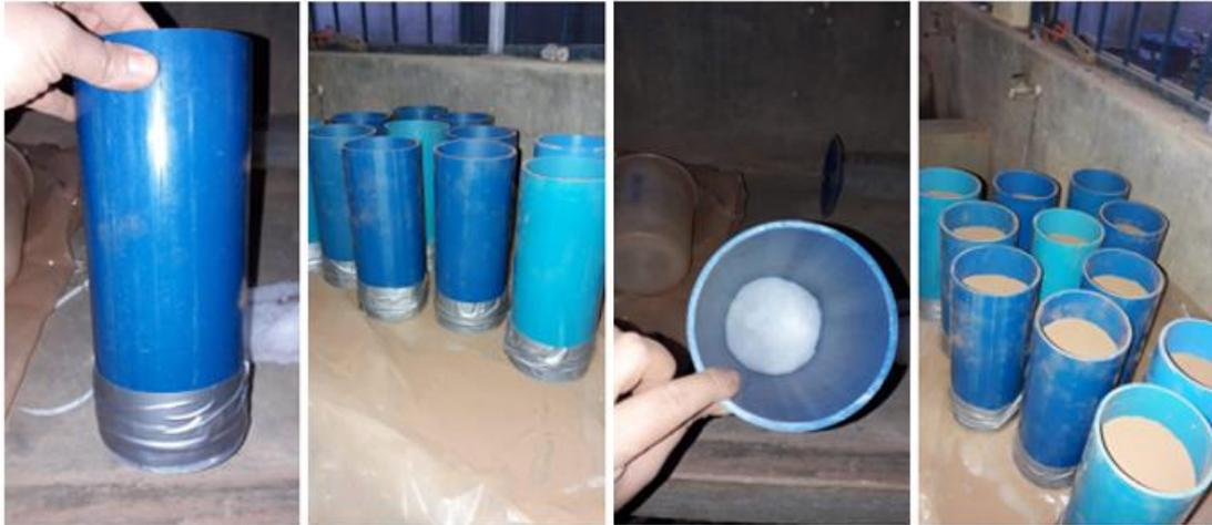
**Figura 3.** Montagem, preenchimento e visão geral das colunas de lixiviação.
