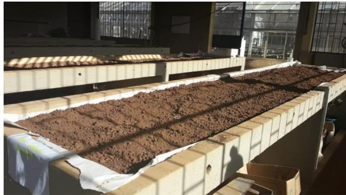
**Figura 2.** Rejeito disposto em bancadas para secagem ao ar.
