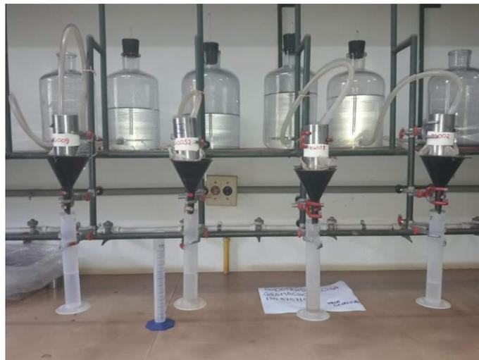
**Figura 6.** Condutividade Hidráulica Saturada do Rejeito por meio do método do permeâmetro de carga constante.
