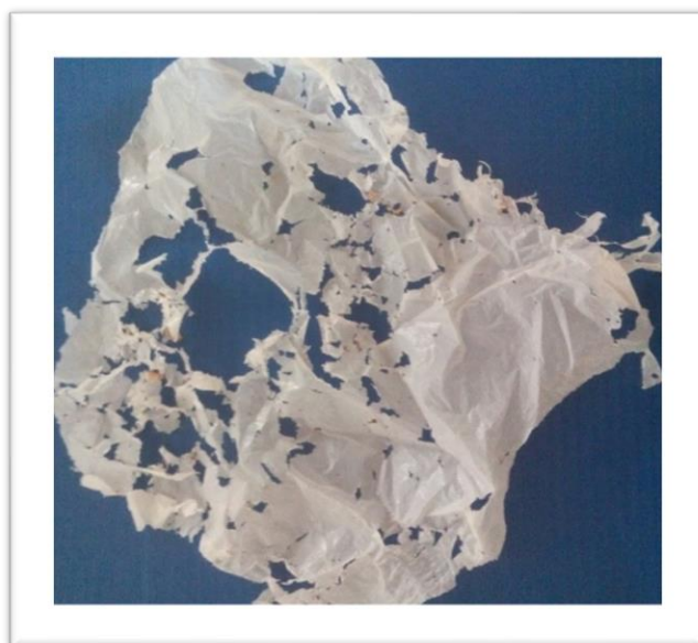
Figura 1. Polietileno (PEAD) após 10 dias de consumo por larvas de T. molitor .
