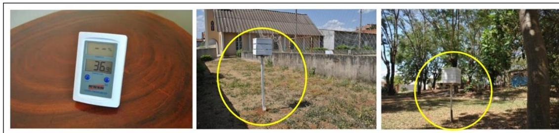
Figura 3 - Termohigrômetro HT-200 e mini abrigos de madeira
